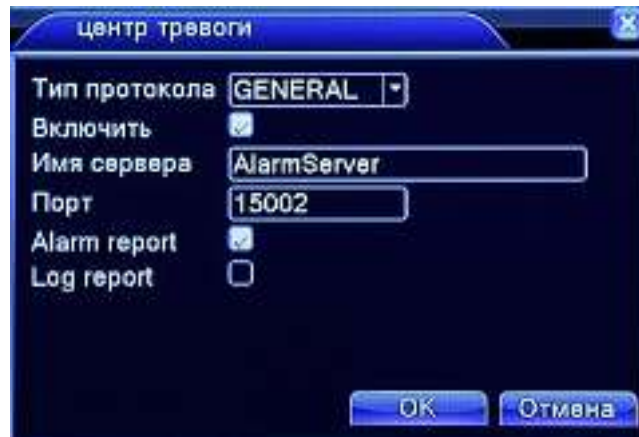
Рис. 4.23 Установки Центра тревоги ARSP
